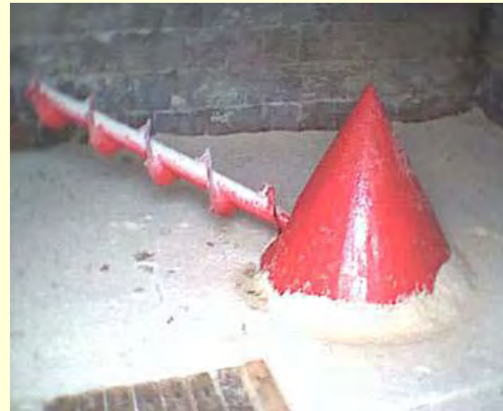
UNUTRAŠNJI DEO SILOSA - IZVLAKAČ
